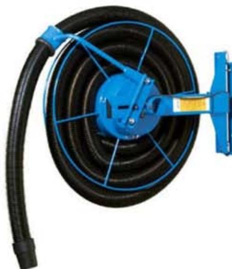
Les enrouleurs sont munis d'un mécanisme à ressort pour le rappel du flexible. Lorsque l'utilisateur déroule le flexible, le bras ouvre le clapet d'aspiration et un micro contact électrique permet de démarrer à distance une éventuelle centrale d'aspiration. Les flexibles fournis avec les enrouleurs sont antistatiques.
