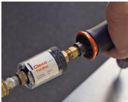
Surveillance du temps de fonctionnement pour contrôle des performances et du service
