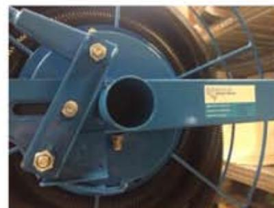
Piquage Air comprimé 1/4G ou raccord rapide rilsan 8/10
